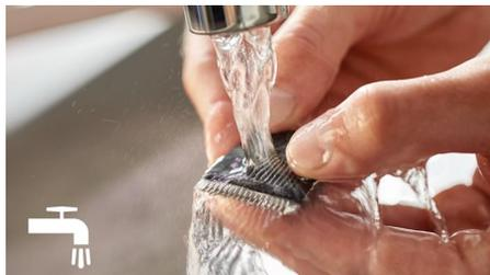
Для удобства при очистке снимите головку и промойте под струей воды. Прежде чем снова прикрепить к прибору, полностью просушите ее.
